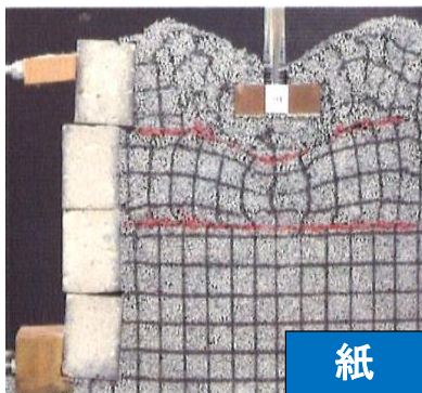
図-7 地盤の変形(補強材が紙2枚)
